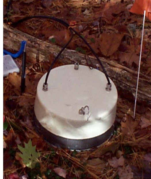
Fig. 28. Câmara de PVC para coletar gases-estufa do solo.
