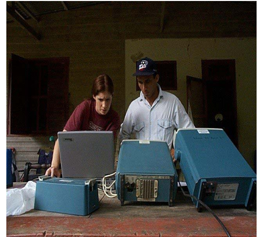
Figura 8. Registrando a umidade do solo através de sensores de umidade.
